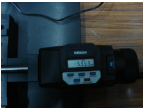
量測平台之 Y 軸 Mitutoyo 量測儀固定，X 軸 Mitutoyo 量測儀右偏移方式從 GOLD PLATE 量測至 RJ-45ABS 側面之間的距離
